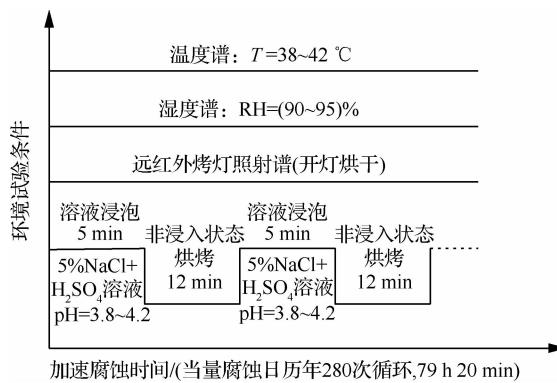
图 3 加速腐蚀试验环境谱
