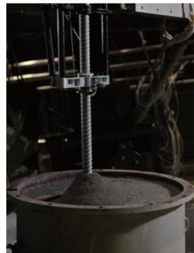
图 4 钻取采样试验装置
